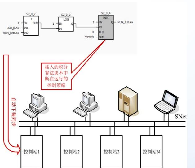
系统提供的基本算法块是系统内不可分割的实现特定功能的算法模块，用户基于基本算法块组态的算法程序或者外部导入程序可以通过定义封装为系统的基本算法块。基本算法块完全封闭式运行，并且独立运行于其他基本算法块和算法程序，采用算法块分页、分组的在线调试与运行监视机制，单个算法块的运行错误不会影响到其他算法块的执行。
