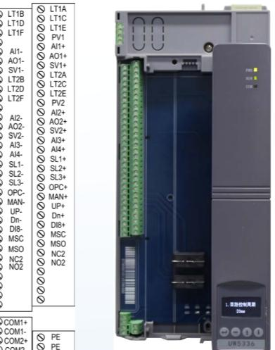
UW5336是汽轮机DEH专用阀门伺服控制模块, 其主要工作原理为接收主控模块输入的控制目标, 结合阀位反馈, 经过专用算法处理, 输出信号驱动电液伺服系统, 完成汽轮机阀门的伺服控制。
