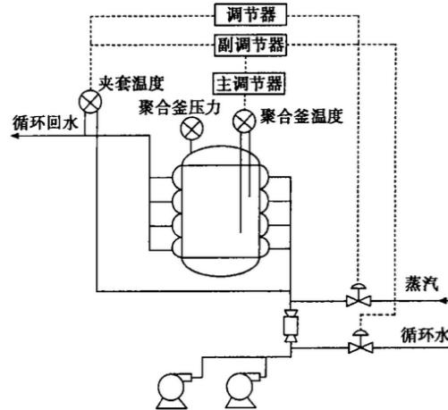
图4 聚合釜温度控制流程示意图
