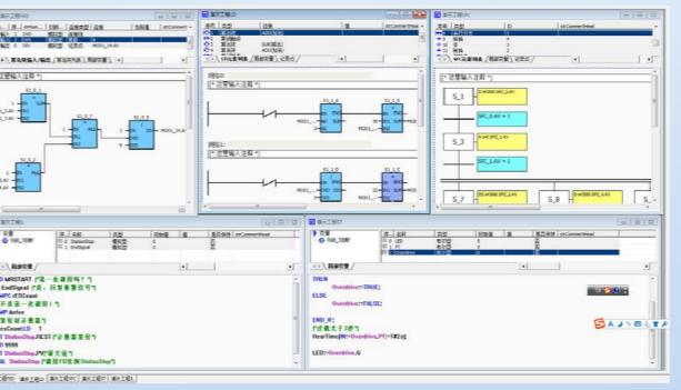
在现有的五种编程语言中，ST和SFC可以实现整体在线编程与局部在线编程，FBD和LD不仅可以实现上述两种编程，还能实现彻底在线编程。在算法编辑界面，点击“”按钮，便可进入在线编程状态，之后进行的操作便会自动下装到控制模块中。为了保证在线编程的顺利进行，会事先对算法的操作站版本号与控制站版本号进行检验，若检验出版本号一致，方可进行在线编程。取消在线编辑，再次点击“”按钮即可。
