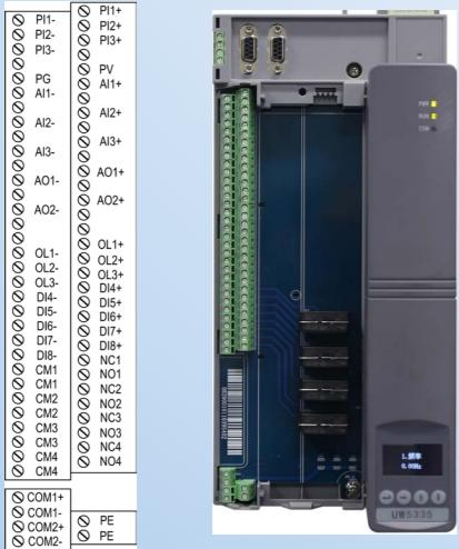
UW5335汽轮机DEH测速与超速保护模块是汽轮机控制系统专用模块。它接收现场的汽轮机测速装置发来的电信号得到汽轮机的精确转速, 还接收油开关跳闸的DI干接点信号和上位机指令, 进而发出快速可靠的汽轮机超速信号。该信号通过继电器输出驱动超速保护电磁阀和危急遮断电磁阀, 实现汽轮机超速限制、保护功能和机械超速试验备用保护功能。
